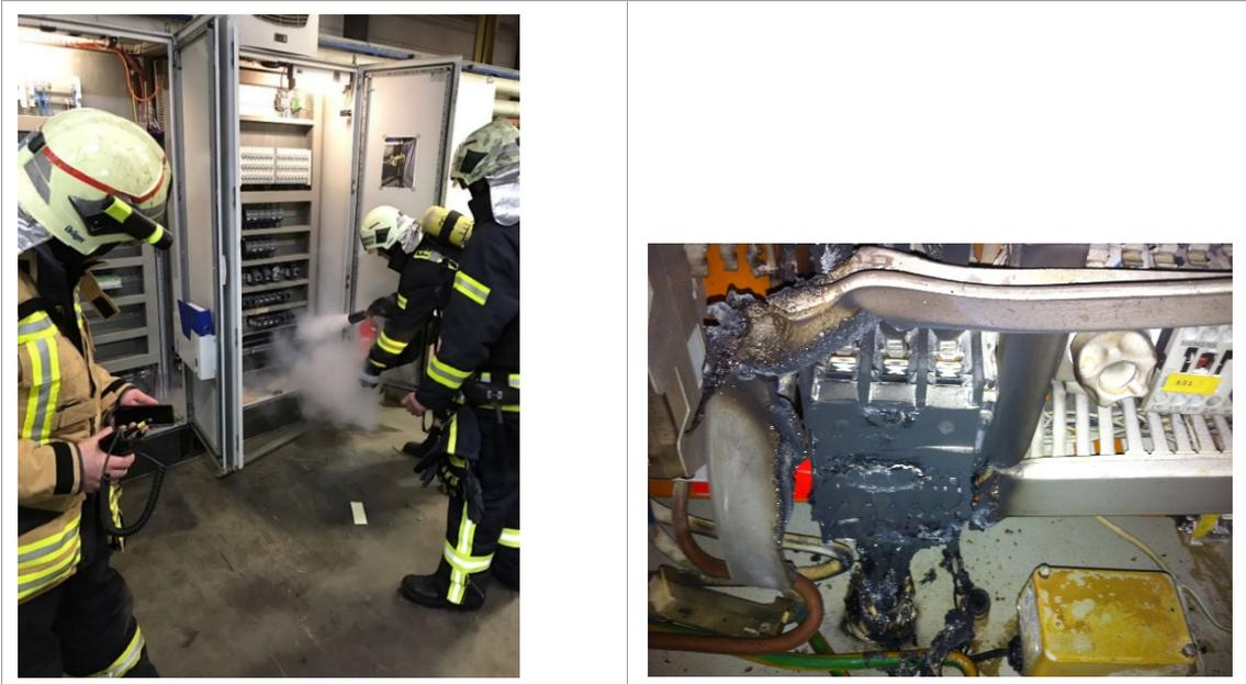
Abbildung 2: Entstehungsbrand in einem Schaltschrank (links) und eines Gleichrichters (rechts). (© J. Zimmermann, FB CBRN, Erzgebirgskreis)
